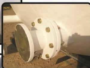
Fabricados pelo processo Hand-Lay-Up, as espessuras de flange são definidas conforme a norma NBS PS 15.69 de acordo com sua classe de pressão, a recomposição do laminado de acordo com a norma ASTM D-4097
